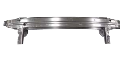
1,470MPa級超ハイテンを使用したバンパーレインフォースメント
