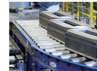
▲製造ラインを移動する変圧器用コアの中間製品
