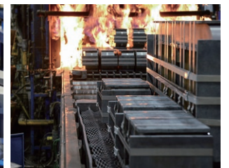
▲性能を向上させるための加熱炉から出てきた変圧器用コア
