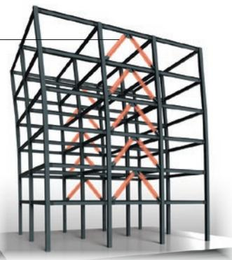
建物の耐久性向上に寄与しています。ブレースとは、鉄骨造の建築物に強度を持たせるために、柱や梁の間に斜めに設置する部材のことで、建物の外周部にも取り付けられることから、新築だけでなく既存建物への補強も可能です。JFEスチールグループでは、低層の物流施設から超高層建物まで適用できる、幅広いラインナップのブレースにより、建物の安全を守っています。
