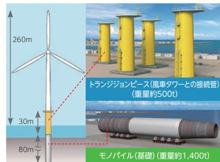
風車の基礎としてのモノパイルと風車タワーとの接続のためのトランジションピースで構成される、極厚・大口径・長尺の超重量物です。欧州では主流の方式で水深の浅いところで活躍します。
