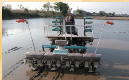
▲ 鉄コーティングされた籾を直接水田にまく
