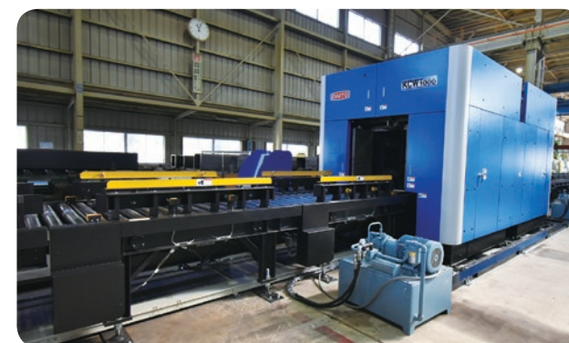
▲新たに導入した1,000ミリ幅コラム切断機
