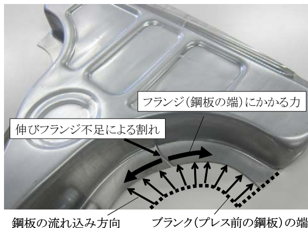
【伸びフランジ不足による成形割れ事例(ピラーロア)】
