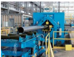
▲電縫管製造設備
