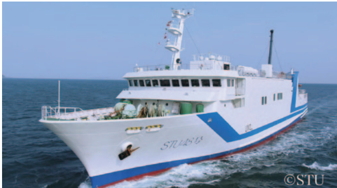
船上劇場STU48号 全長77.8mの既存船の2層分を改造して劇場を据え付け(JMU因島工場)
