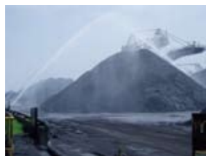
原料ヤードへの散水
