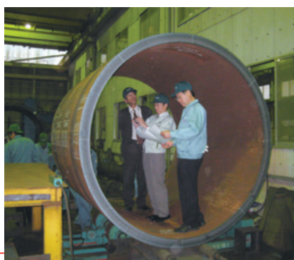
塔体最下部に使用された大径極厚円形鋼管
