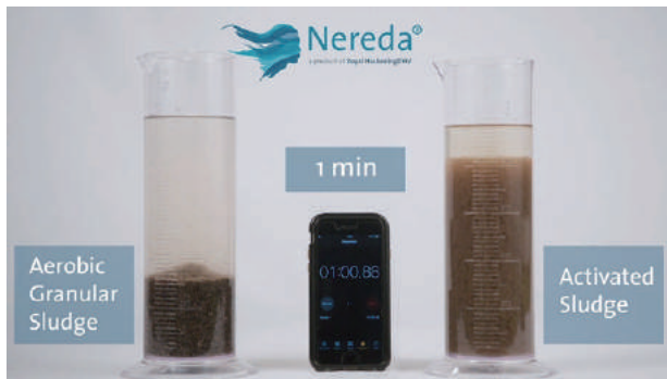
1分間の沈降分離状況(左：好気グラニュール、右：活性汚泥)。下側が微生物群で上側が浄化された水。
