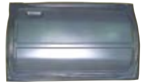
高張力鋼板の適用例 (当社 1200 トンプレス機によるドアパネル試作例)
