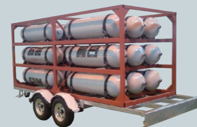
バイオガス540m 3 が入る軽量カーボン容器
