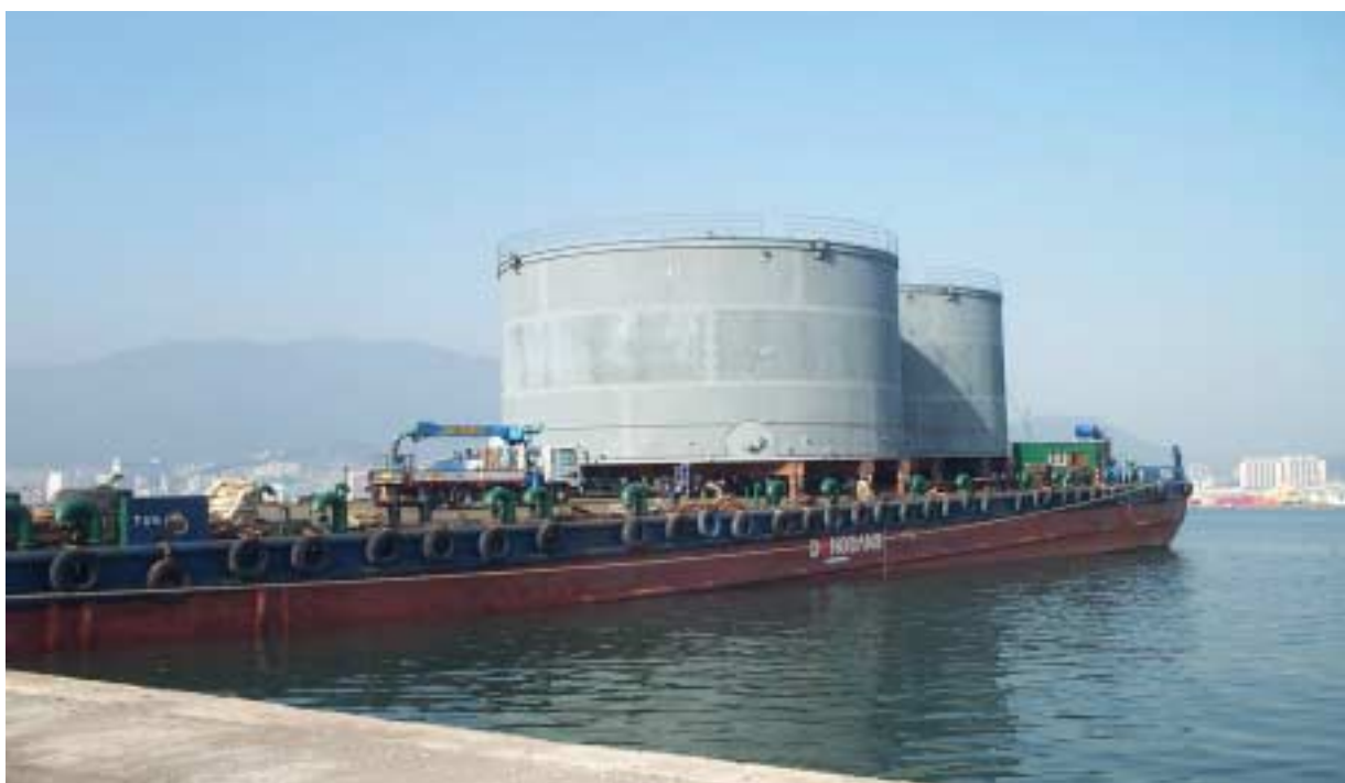
【写真 2】製作完了後、出航のため船積み中のメルトピッチ出荷用タンク
