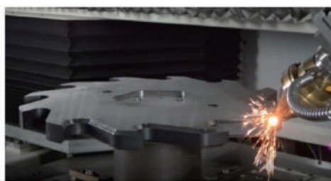
金属 3D プリンターによる補修部の積層造形
