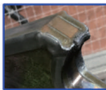
積層造形後の補修部
