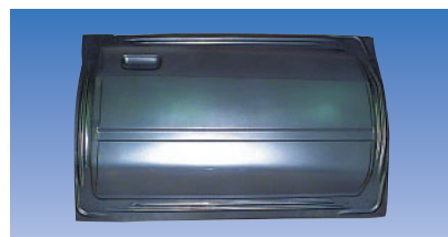
自動車用高張力（ハイテン）鋼板 ※JFEスチール1,200トプレスによるドアパネル試作例
