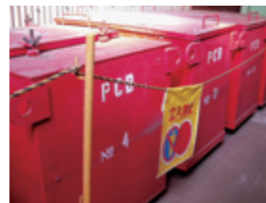
PCBを含んだ機器類の保管状況
