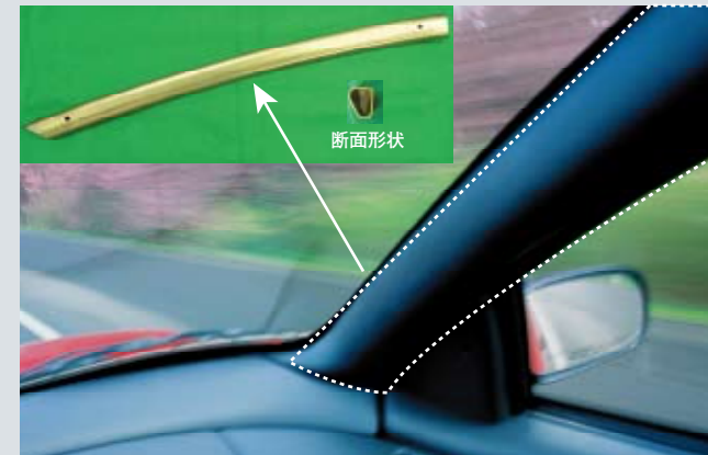
フロントピラーの補強部品への適用事例。ピラーをより細くできるため良好な前方視界が得られます。
