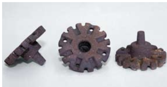
サンゴ幼生用着床具(基本形状 東京海洋大学・岡本准教授開発)
