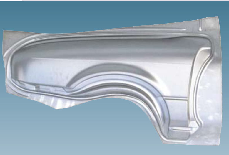
1,200 t actual press test (Fender model)
