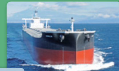
燃費向上を実現する船首形状を採用したLEADGE-Bow装備バラ積み船 (ユニバーサル造船・P48)
