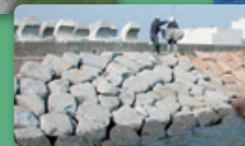
製鉄スラグから製造される人工資材マリンロック (JFEスチール・P40)
