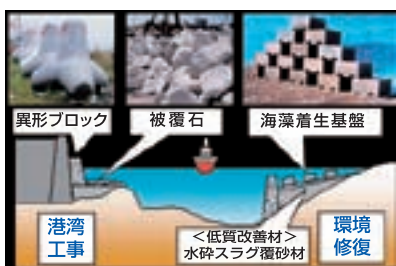
スラグを用いた港湾工事材料・海浜環境修復材料例
