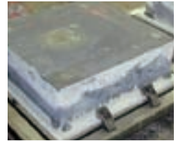
世界最大サイズの多結晶シリコンインゴット
