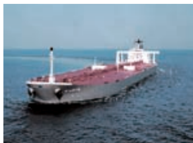
TMCP型高張力鋼板を用いたタンカー
