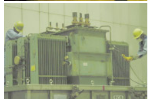
JESCO北九州事業所でのトランス積み下ろし作業
