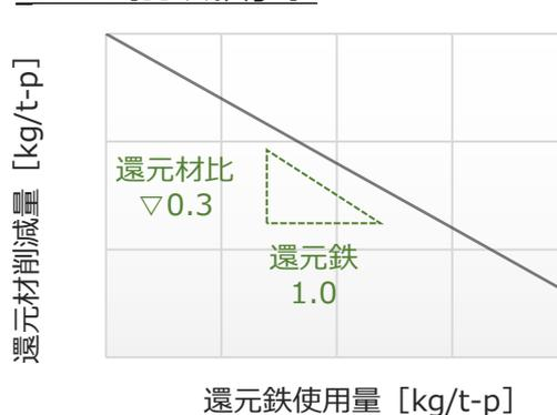
高炉へ還元鉄を多量に装入することで、コークス（還元材）使用量を大幅に低減
