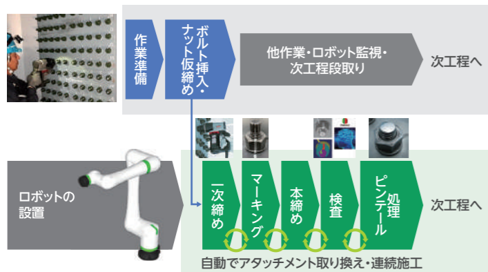
協働ロボットを用いたボルト締め付けワークフロー
