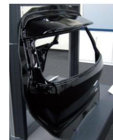
新しい成形技術を用いて加工した自動車のバックドア
