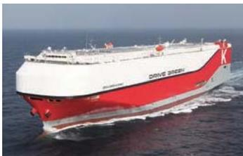
有明事業所で建造した川崎汽船向けの自動車運搬船「DRIVE GREEN HIGHWAY」は、パナマ運河拡張に対応した幅広新船型の次世代型自動車運搬船です。大幅な積載車両数の増加を実現しながら、低燃費技術を採用することにより、既存船対比で輸送車両1台あたりのCO<sub>2</sub>排出量を約25%削減します。積載貨物は一般的な乗用車のみならず重機類・鉄道車両なども搭載可能なデッキ構成となっています。本船は川崎汽船が立ち上げた「DRIVE GREEN PROJECT」のフラッグシップとして、環境性能に特化する機器を搭載する次世代の低燃費・低CO<sub>2</sub>排出船です。
