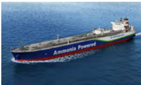
アンモニア燃料アンモニア輸送船 (イメージ図)
