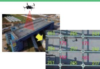
橋梁の施工現場における配筋検査について、ドローンによる写真撮影と画像認識AIを活用して配筋検査を自動化する世界初のシステムを開発。計測時間と人員の効率化に寄与
