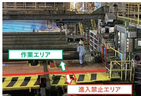
AIカメラが人物を検知すると設備の稼働を自動で停止（JFEスチール）
