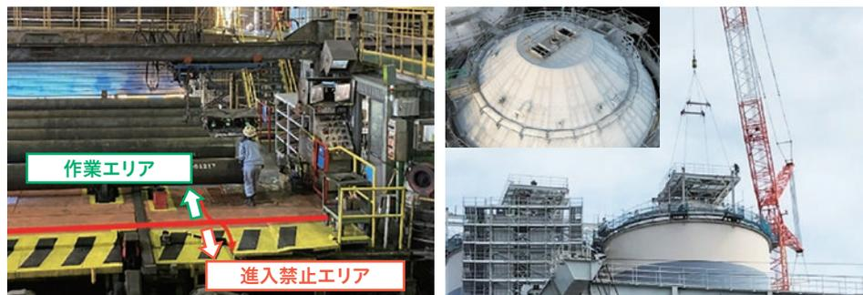
AIカメラが人物を検知すると設備の稼働を自動で停止（JFEスチール）
