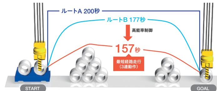
クレーン作業を自動化する技術です。クレーンの操作を自動化する技術、運搬対象物の置場管理システムおよび搬出順自動配替システム等で構成され、対象物の搬入、置き換え、搬出を自動で行うことが可能です。JFEスチールの複数のグループ会社と連携して技術提供を進めています。
