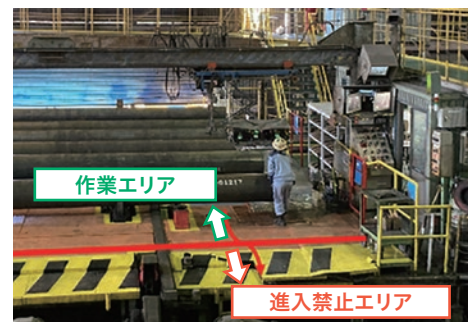
AIカメラが人物を検知すると設備の稼働を自動で停止（JFEスチール）
