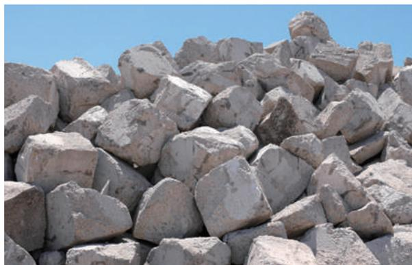
鉄鋼スラグ水和固化体製人工石材
