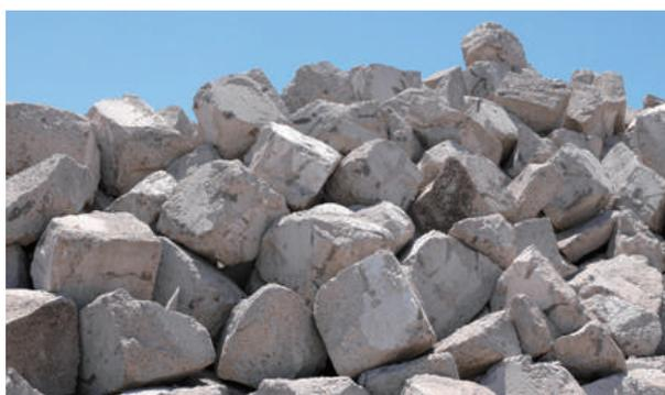
鉄鋼スラグ水和固化体製人工石材
