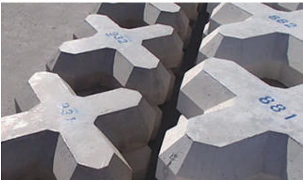
消波根固ブロック
