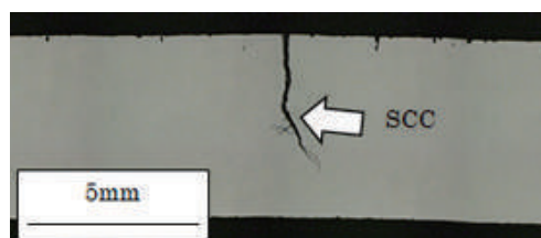
■ 図2：試験により発生した応力腐食割れの事例
