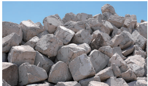
鉄鋼スラグ水和固化体製人工石材
