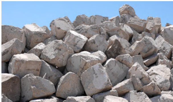
鉄鋼スラグ水和固化体製人工石材
