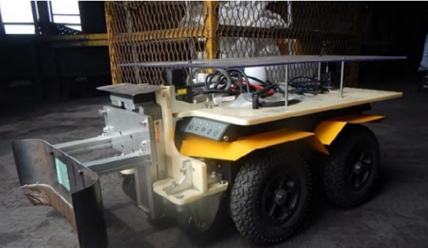
■ 画像1：高能率自走式清掃ロボット
