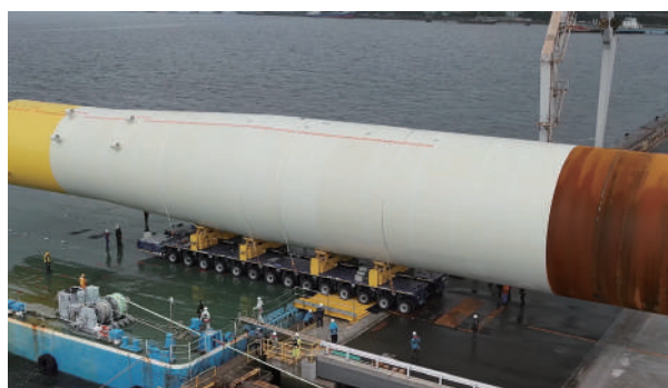
モノパイル試作品(直径約10m×長さ60m重要1,000トン規模)
