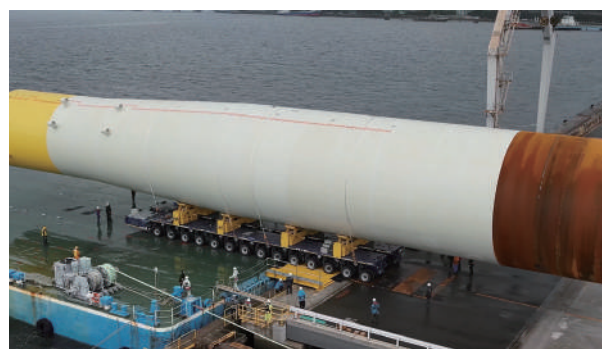
モノパイル試作品 (直径約10m×長さ60m重量1,000トン規模)
