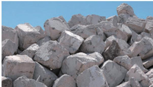
鉄鋼スラグ水和固化体製人工石材
