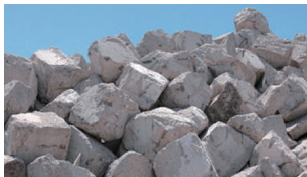
鉄鋼スラグ水和固化体製人工石材
