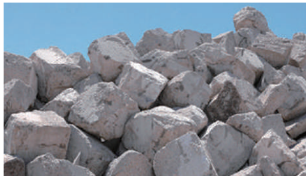
鉄鋼スラグ水和固化体製人工石材
