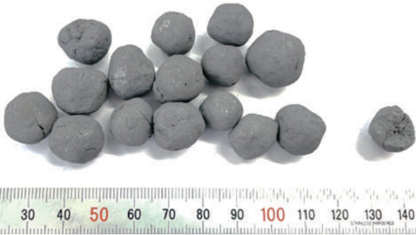
グリーン水素により試作した還元鉄 ※4
