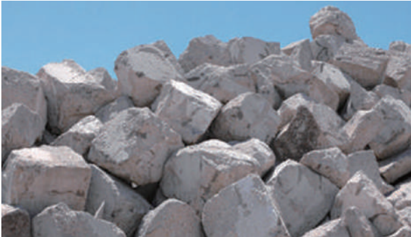
鉄鋼スラグ水和固化体製人工石材
