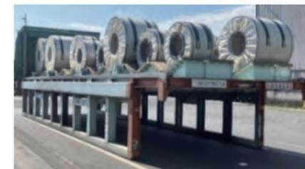
【図2】パレットに積載された薄板コイル製品
