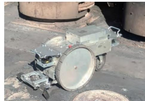
【図1】難条件対応型自走式清掃ロボットGAZMASTER™
