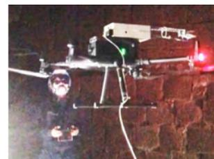
ドローンに搭載可能なレーダ装置（1GHz～1000GHzの任意の周波数と帯域に対応）により、物質を透過して対象内部の遠隔検査が可能に。
