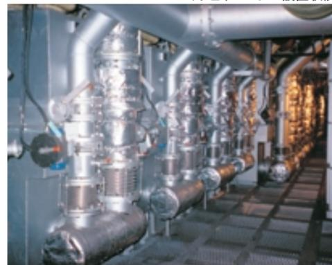
リジェネバーナーは、蓄熱体と一体化した一対2台のバーナーを交互に燃焼させ、排熱で他方のバーナーの燃焼用空気を予熱するものです。熱効率に優れ、大幅な省エネルギー（CO<sub>2</sub>削減）とNOx低減を達成しています。
