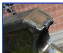
積層造形後の補修部
