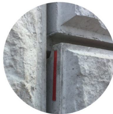
フェイルセンサー作動時 (赤色の変状サインで内部異常を可視化)
