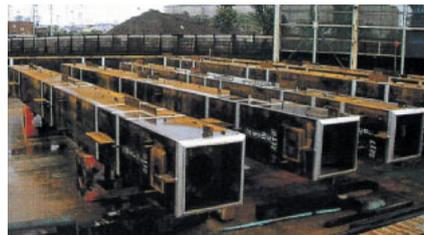
建築構造用550N/mm<sup>2</sup> TMCP鋼材
