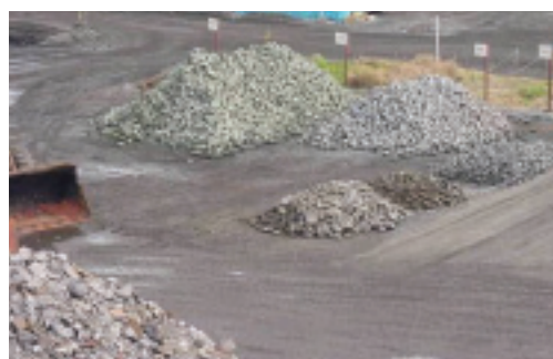
廃レンガ再利用のための分別状況:東日本製鉄所(京浜地区)の例
