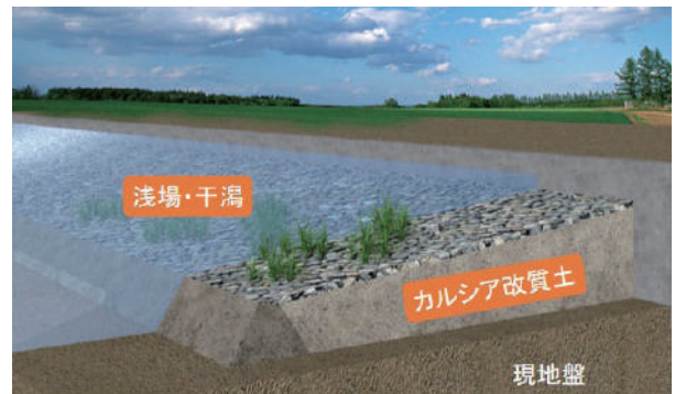
カルシア改質土の適用例（浅場・干潟造成材）
